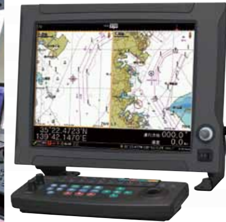
左：出倉佑樹さんにお話し、航海中のイメージでブリッジに立ってもらった。左手で操作しているのが、ニューベック搭載のGPSプロッター（日本無線JLZ-1000） 右：日本無線の「JLZ-1000」。ニューベックのデータを間引きすることなく全て収載し、スムーズな動作性を実現。ディスプレイのサイズも、10インチから大型の26インチまで、豊富なバリエーションがそろった（問）日本無線（TEL: 03-6832-1821）
