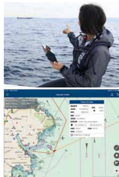
出航して浦賀水道航路に近づくと、大型船が往来している(上)。さっそく「ニューベックスマート」でチェックすると、すぐに該当するフネがわかった(下)。船名(TONG LIN WAN)というタンカーで、180度の方向に12.8ktで進んでいることが読み取れる
