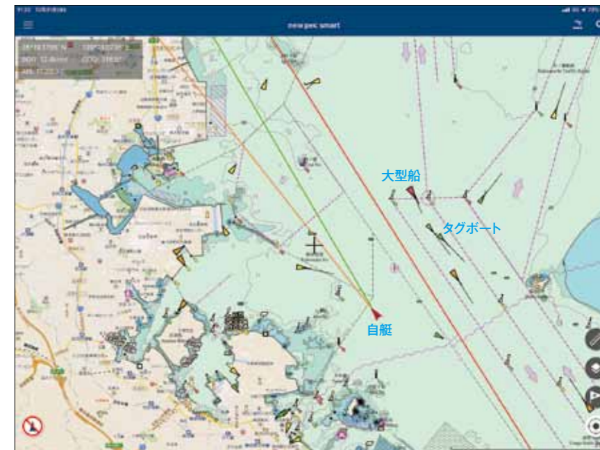
画面ほぼ中央の赤い△マークが自艇で、矢印の向きが進行方向。ピンクの点線の航路内を走っている△(赤)が大型船で、それを曳いているタグボートが△(緑)の2艇だ。その前方の△(オレンジ)は、大型船の△(赤)よりやや小さく、色分けされて表示される
