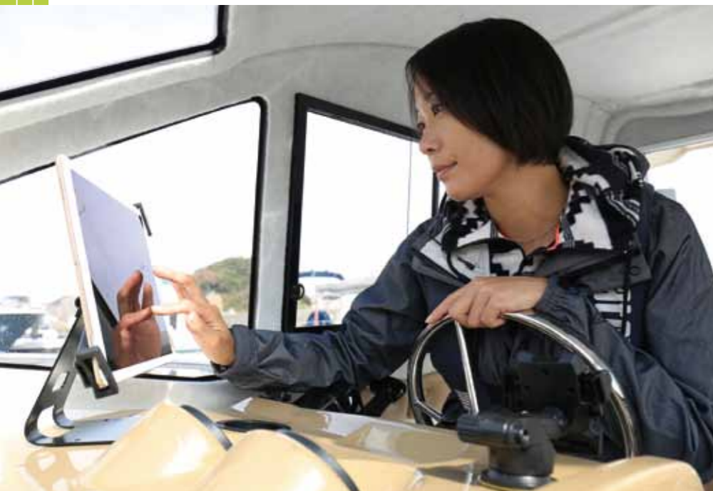
12.9インチのタブレットを、ヘルムステーションに設置。出航前に、アプリ内の「計画作成」メニューでコースを設定し、危ない箇所がないかチェックする。タッチパネルで拡大・縮小が簡単にできて、使い勝手は抜群
